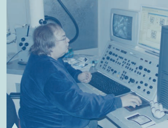
Materialprüfung mittels Rasterelektronenmikroskop, Bild: VPA
