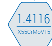
Molybdänhaltiger Stahl: Durch die Beigabe von Molybdän beständig gegen Punktkorrosion
